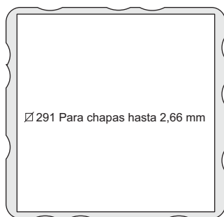
PERFORACIÓN PARA MONTAJE
