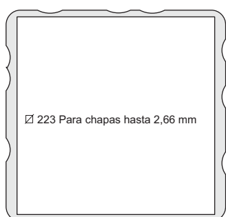
PERFORACIÓN PARA MONTAJE
