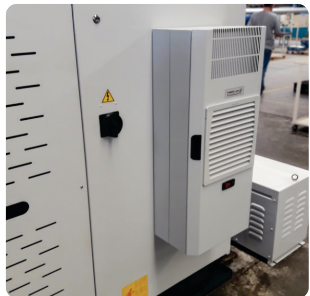
Aire acondicionado | Enfriador TASCO aplicado al tablero
