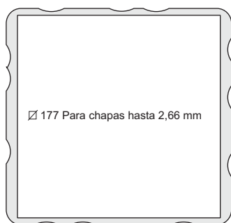
PERFORACIÓN PARA MONTAJE
