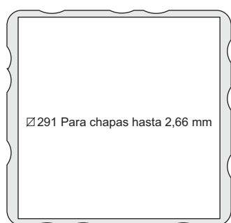
PERFORACIÓN PARA MONTAJE
